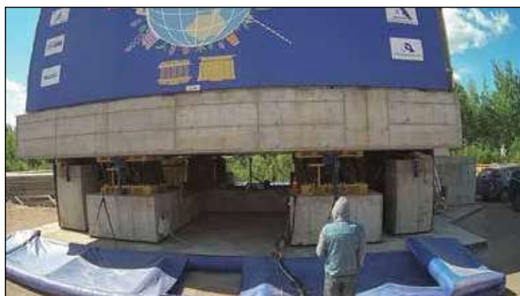
Рисунок 5 – Испытания системы BCS на специальном вибростенде ООО «ЦВС» (г. Санкт-Петербург)
